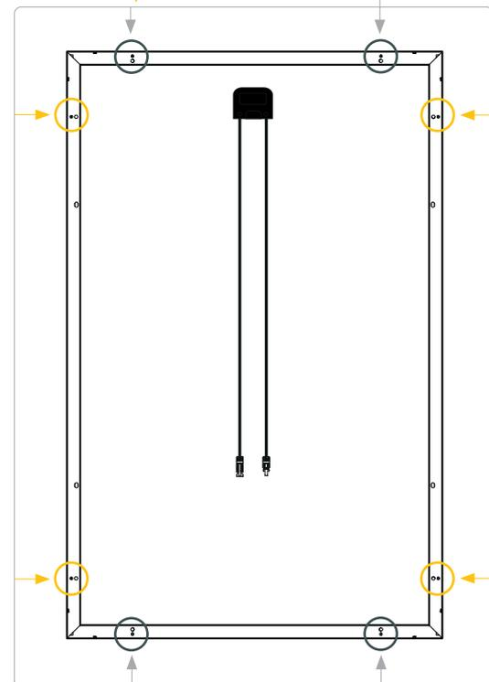
Die Erdungsklemme ist an einem der dafür vorgesehenen und extra gekennzeichneten Erdungslöcher auf der Rückseite des Modulrahmens zu befestigen.
