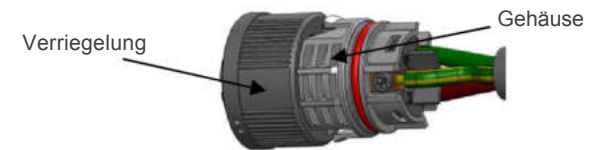
Abbildung 4.16 Anschließen der Drähte an die Klemme
